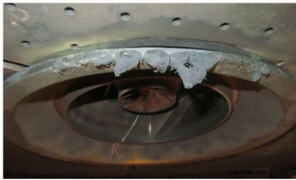
اینتر رینگ های چمبر چپ تعویض گردد. عملیات تعویض قطعات از تاریخ ۹۳/۰۷/۵ توسط پرسنل تعمیرات مکانیک بخش گاز نیروگاه آغاز و پس از طی مراحل باز کردن اتصالات بالای چمبر چپ و باز کردن پیچهای top dome، insert rings، flame tube، آماده کردن و نصب پیچ های segment plates، سوراخ کاری و نصب segment plates، آماده کردن و نصب پیچ های insert rings، flame tube، آغازن کردن top dome رینگها، جازدن و بستن پیچهای
