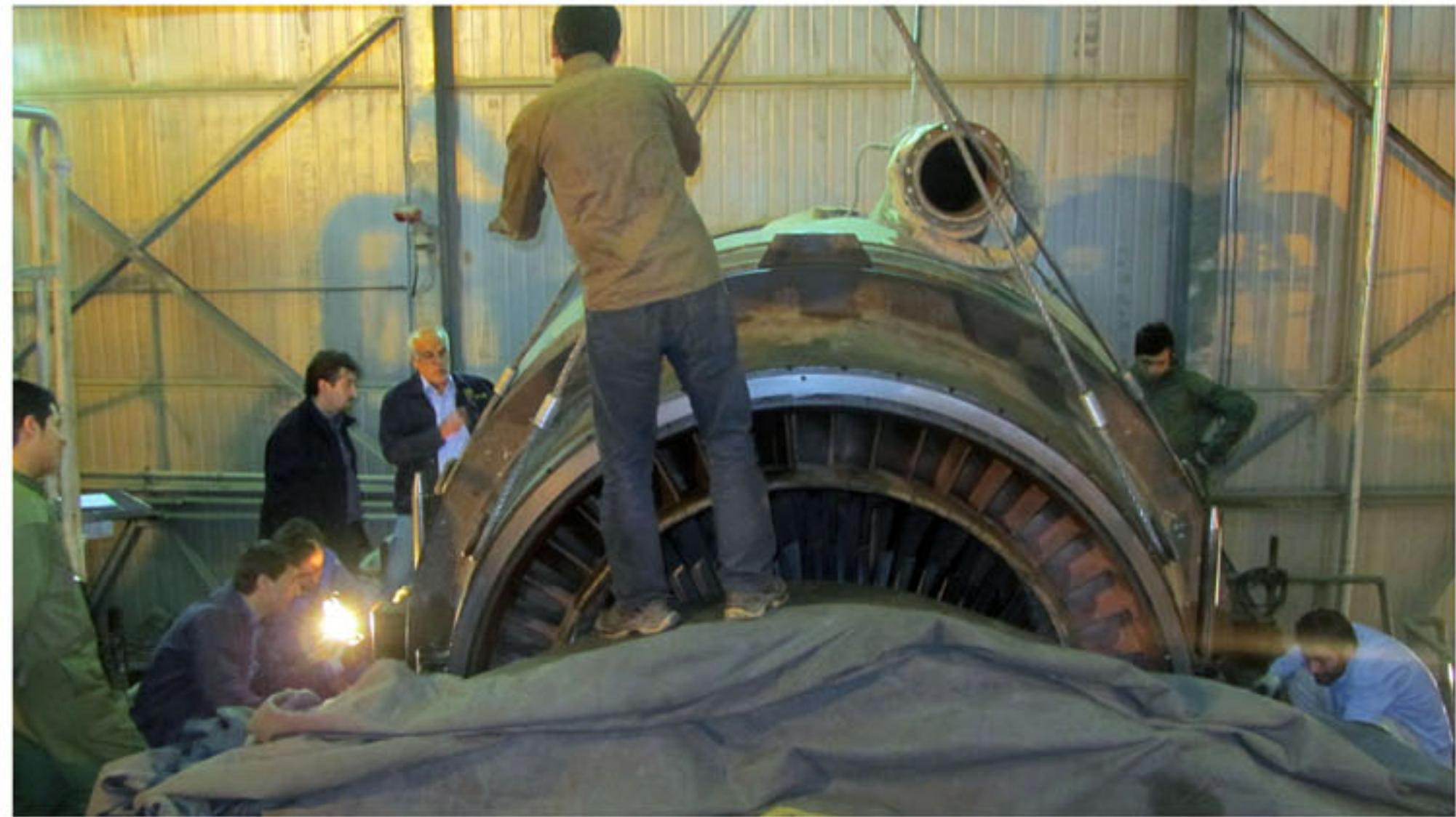
با بر اخبار بدست آمده پس از رویت ترک و شکستگی های ایجاد شده در پره های توربین واحد گازی ۱۵۹ مگاواتی G15 نیروگاه سیکل ترکیبی شهدای پاکدشت(دماوند) در جریان بازدید دوره ای ۴۰۰۰ ساعته، واحد مذکور جهت عملیات تعویض پره های توربین در تاریخ ۹۳/۸/۵ از مدار خارج شده و با پایان یافتن عملیات تعمیرات در مشکلی با شبکه سراسری سنکرون گردید.
